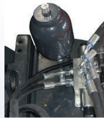
Ein- oder Zweihydraulikspeicher je nach Steuergerät am Fahrzeug
